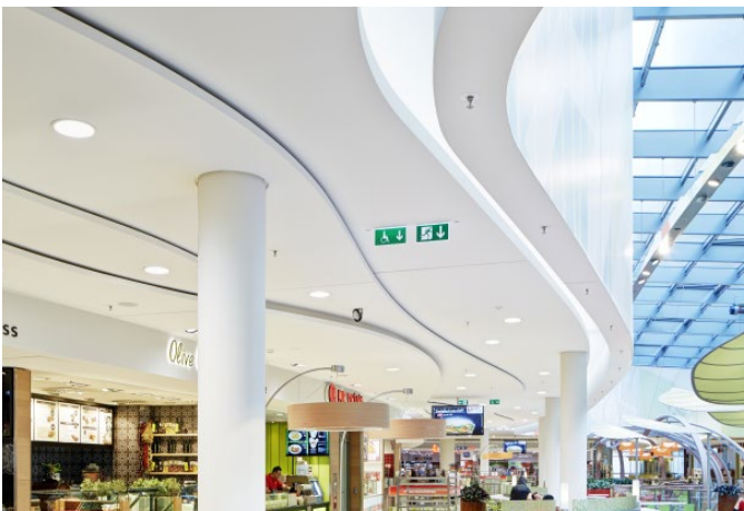
Versetzte Deckenebenen lockern die großen Flächen auf. Die Voraussetzung für eine perfekte Oberfläche schufen hier Knauf Horizonboards mit umlaufenden abgeflachten Kanten.
